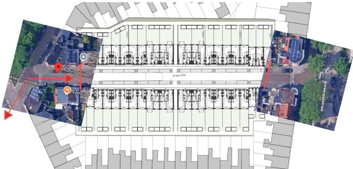
Afbeelding 4 Situatietekening in- en uitrit bouwverkeer
